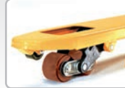
Tandemrolle: 2 Rollen in jeder Gabel – wippend gelagert. Vorteilhaft bei unebenen Böden, Kanten und Schwellen. Kletterrollen an den Gabelspitzen.
